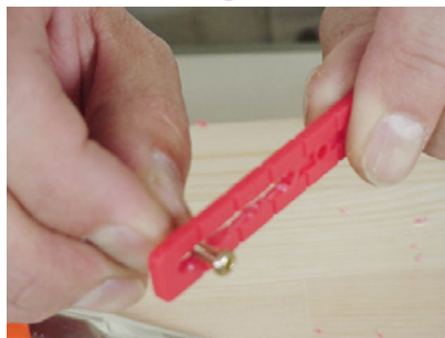
ヤスリでバリを取ったら完成。ビスを通して確認しましょう。
